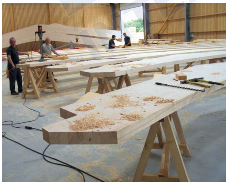
Ligne de production pour la coupe en longueur du bois massif et le rabotage avec une 4 faces CM Machine.
